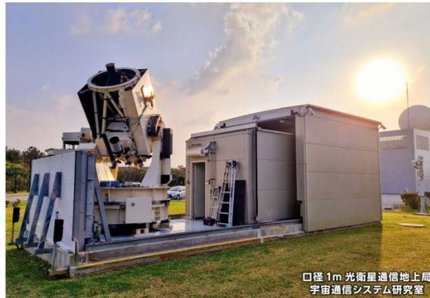
光通信ってきいたから、光ファイバを思い浮かべたけど、光ファイバを衛星につなげなくても望遠鏡をつかって通信できるんだね!しかもこんなに大きい望遠鏡って初めて見たよ!
