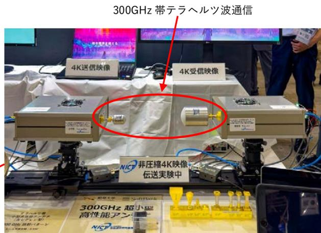
[基盤技術] 300GHz 帯テラヘルツ波による非圧縮 4K 映像伝送システムによるデモ
