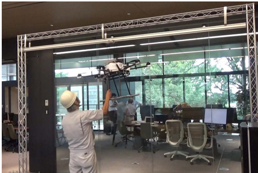
図2 ガントリーローダーに吊り下げられたドローン
