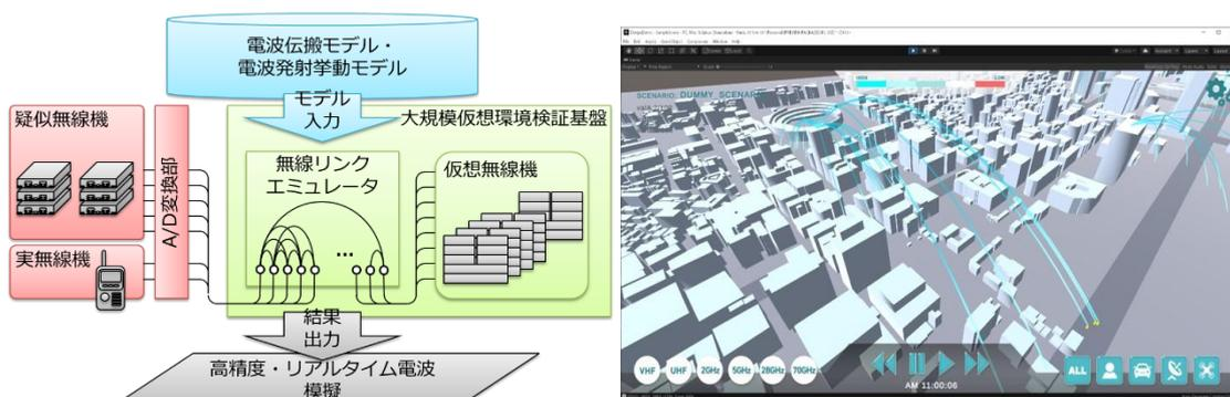
図4.10 大規模仮想環境検証基盤におけるワイヤレスエミュレーションの概要
